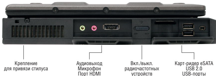
Рис. 6. Расположение портов на левой панели ноутбука S400
