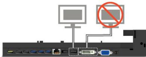
Если при использовании док-станции ThinkPad Ultra Dock подключить два внешних дисплея к разъемам DisplayPort и DVI, разъем DVI будет неактивным.
