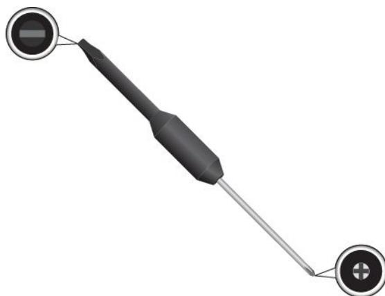
5. Для получения доступа к головкам винтов, расположенным под рамкой клавиатуры, воспользуйтесь плоским торцевым концом многофункционального инструмента из комплекта поставки новой клавиатуры, чтобы сдвинуть рамку клавиатуры вперед на 2,5 мм.
