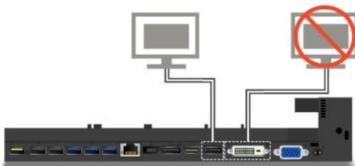
Если при использовании док-станции ThinkPad Ultra Dock подключить два внешних дисплея к разъемам DisplayPort и HDMI, разъем HDMI будет неактивным.
