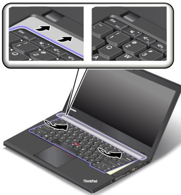
3. Убедитесь, что головки винтов полностью доступны. В противном случае освободите доступ к головкам винтов, сдвинув рамку клавиатуры вперед с помощью плоского торцевого конца многофункционального инструмента для клавиатуры.
