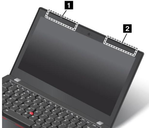
**1** Антенна для беспроводной локальной сети (вспомогательная) и антенна для беспроводной глобальной сети (вспомогательная)
