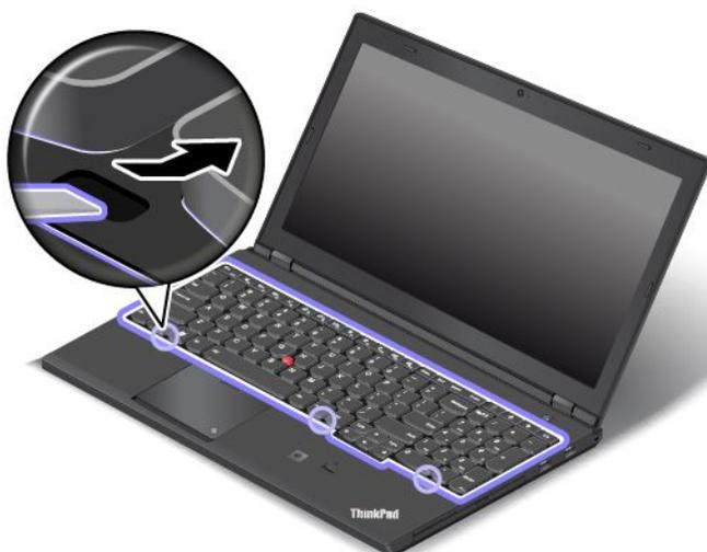
6. Ослабьте винты, которыми закреплена клавиатура, с помощью крестового конца многофункционального инструмента для клавиатуры.
