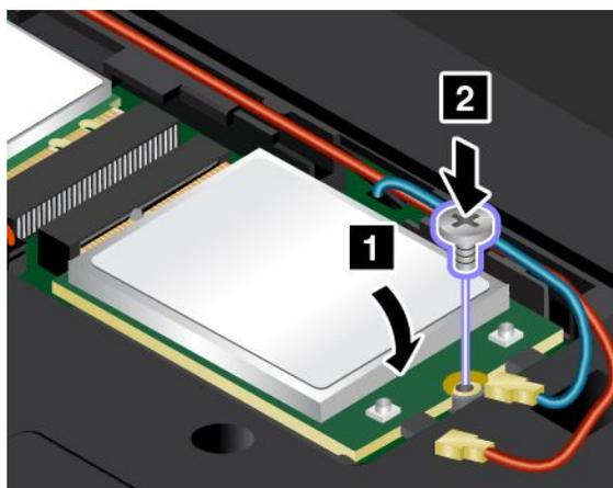
10. Подсоедините кабели антенны к карте беспроводной глобальной сети. Убедитесь, что красный кабель подключается к главному разъему, а синий — к вспомогательному разъему на карте беспроводной глобальной сети.
