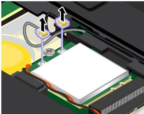
6. Отвинтите винт. Карта беспроводной локальной сети освобождается и поворачивается из своего положения вверх.
