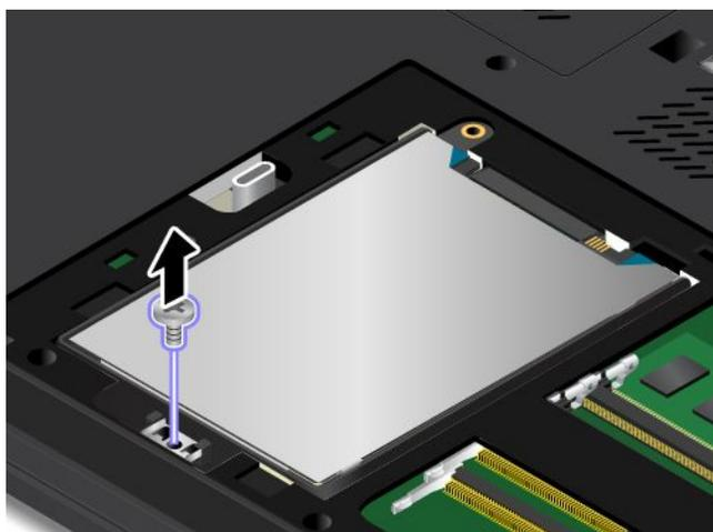
6. Извлеките жесткий диск или твердотельный диск.
