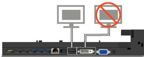
Если при использовании док-станции ThinkPad Ultra Dock подключить два дисплея к разъемам DisplayPort и DVI, разъем DVI будет неактивным.
