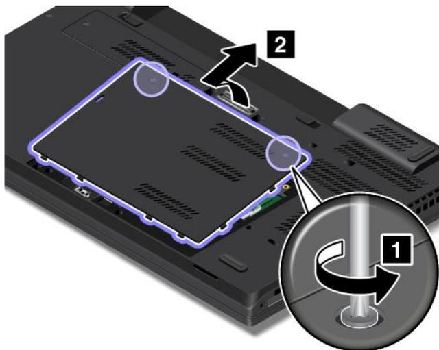
5. Вывинтите винт, которым фиксируется устройство Ultrabay.
