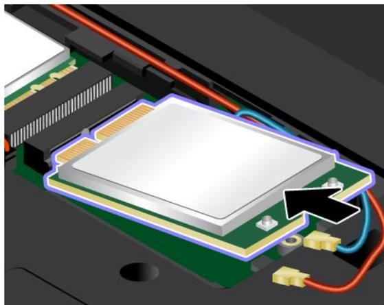
9. Поверните карту беспроводной глобальной сети вниз **1**, а затем установите винт для фиксации карты беспроводной глобальной сети на месте **2**.
