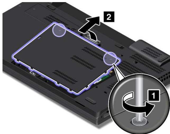
5. Выверните винт, который удерживает жесткий или твердотельный диск.
