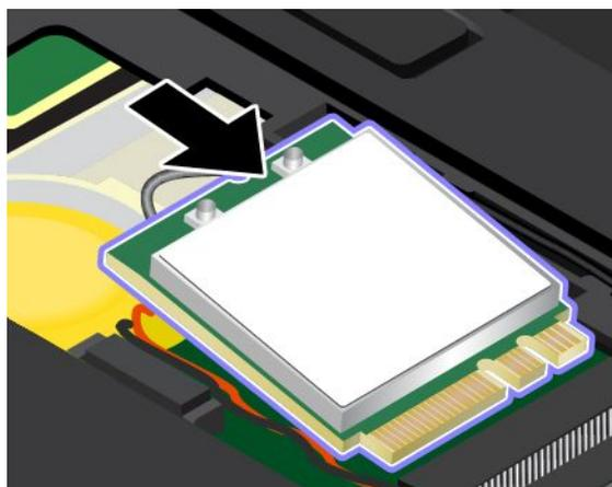
9. Поверните карту беспроводной локальной сети вниз **1**, а затем установите винт для фиксации карты беспроводной локальной сети на месте **2**.
