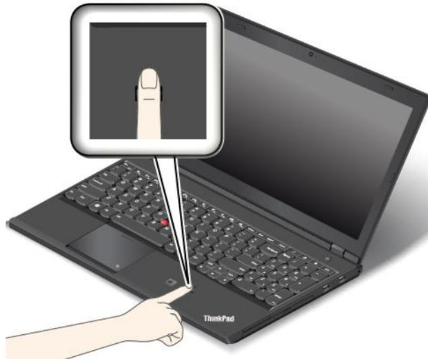
2. Слегка прижмите палец к устройству распознавания и проведите пальцем по устройству к себе одним плавным движением. Не поднимайте палец, когда проводите им по устройству.
