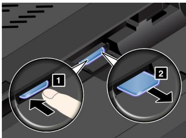
5. Возьмите новую SIM-карту так, чтобы металлические контакты были обращены вверх и к разъему. Затем плотно вставьте новую SIM-карту в гнездо до щелчка.
