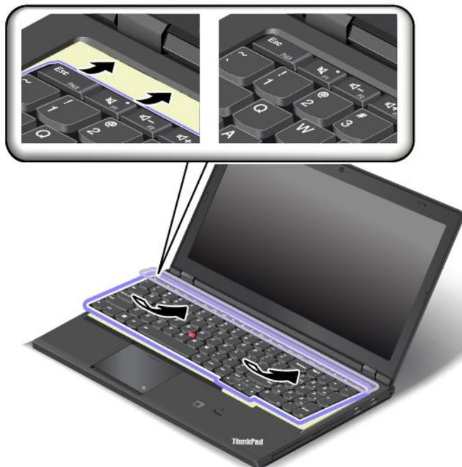
3. Освободите доступ к головкам винтов, сдвинув рамку клавиатуры вперед с помощью плоского торцевого конца многофункционального инструмента для клавиатуры. Убедитесь, что головки винтов полностью доступны.
