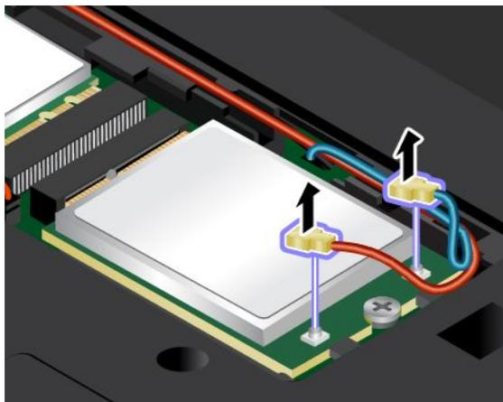
6. Отвинтите винт. Карта беспроводной глобальной сети освобождается и поворачивается из своего положения вверх.
