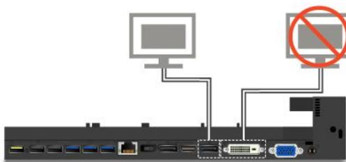
Если при использовании док-станции ThinkPad Ultra Dock подключить два дисплея к разъемам DisplayPort и HDMI, разъем HDMI будет неактивным.
