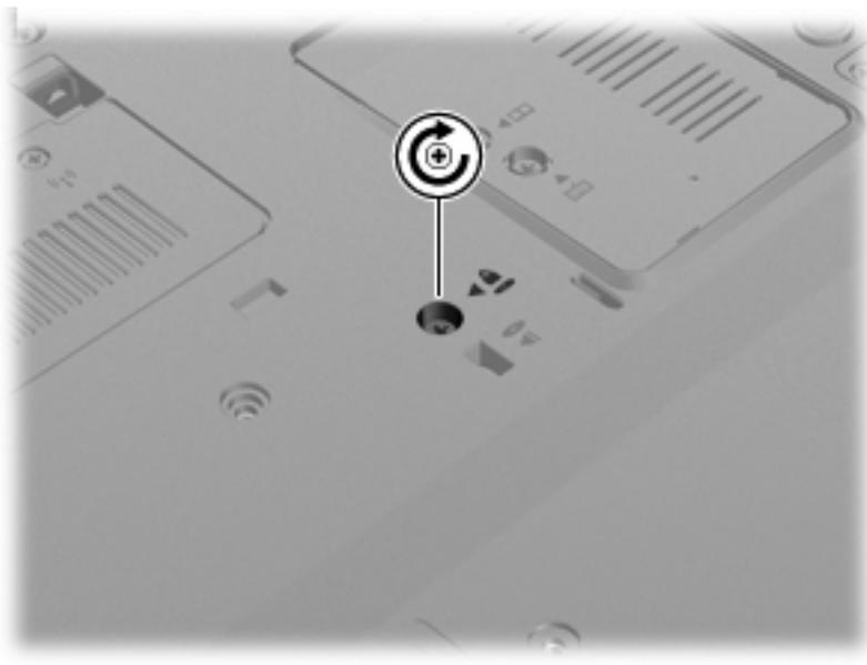
3. Закрутите 4 винта жесткого диска (1) и установите на место защитные колпачки (2).
